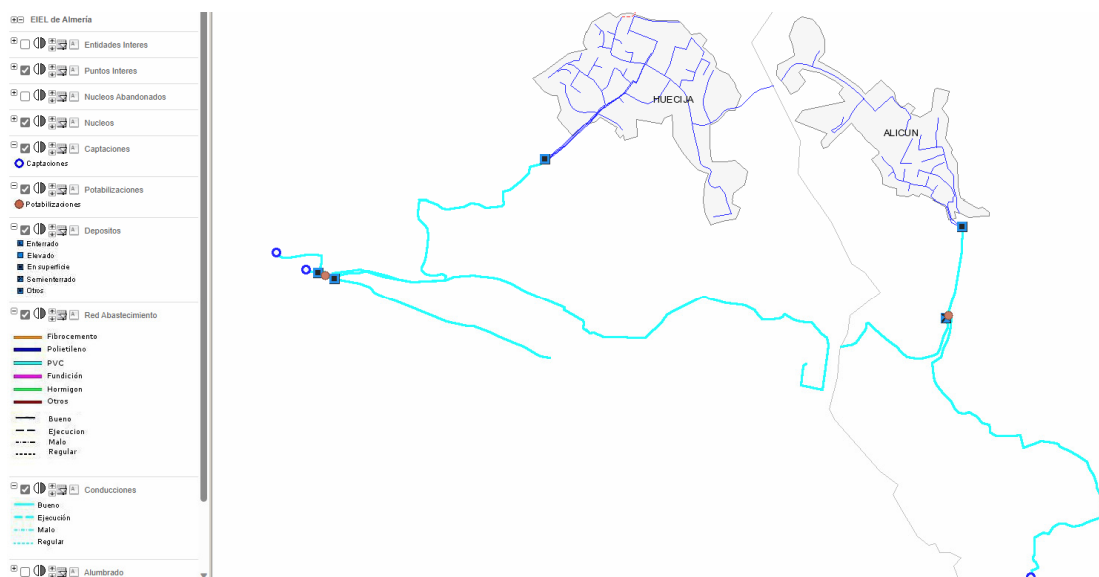
Figura 6: Red de Abastecimiento en alta de Alicún.
